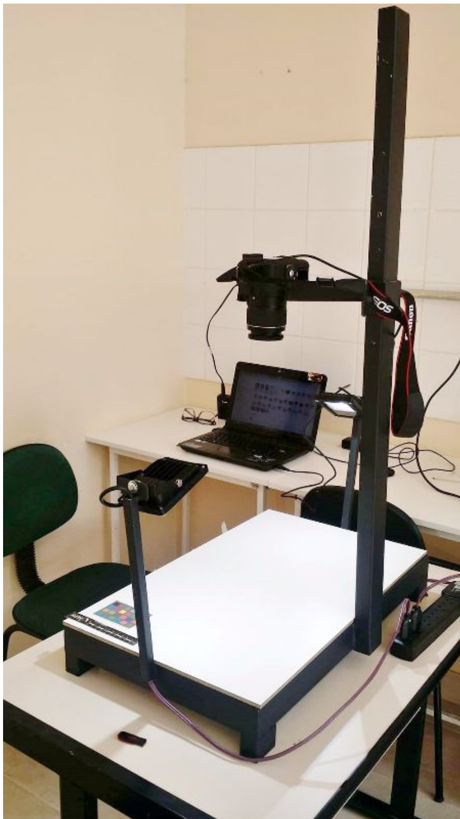
Figura 1. Mesa fotográfica estativa, composta por um braço principal com suporte regulável para a câmera, dois braços laterais com refletores de LED, acoplada a uma mesa composta por uma placa de MDF, parafusada na estrutura metálica, o sistema é acoplado ao computador com um software de controle para a câmera.
